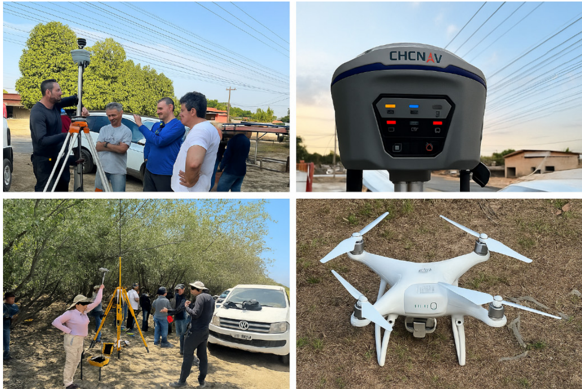
Figura 3. Antena de RTK e drone em funcionamento no campo.
