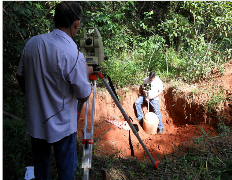
Figura 2 - Vala aberta para a implementação do pseudo-sítio. À esquerda observam-se alguns vasos e a coleta de dados topográficos da vala e das posições dos artefatos utilizando uma estação total.
