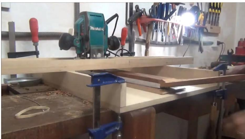
(b) Estrutura de madeira (jig) responsável pelo suporte da tupia manual durante as primeiras etapas de desbaste do braço do instrumento.
