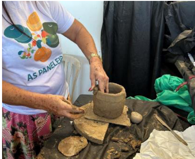
Figura 14. Os roletes são pressionados com os dedos para ficarem na mesma espessura do corpo do caldeirão.
