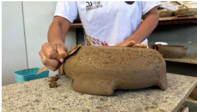
Figura 27. Acabamento feito com a panela virada para baixo, no ponto de couro, com o auxílio do arco na mão direita da artesã.
