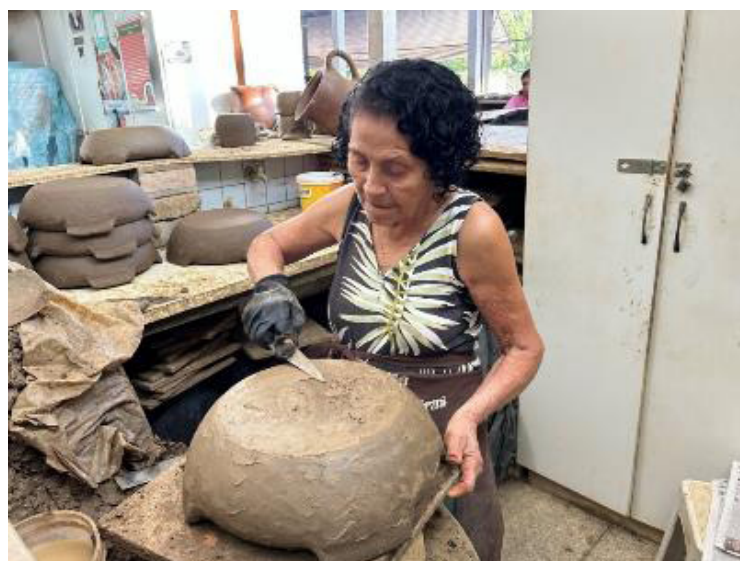
Figura 29. Dona Luci realizando o acabamento com a faca umedecida após a raspagem com o arco.
