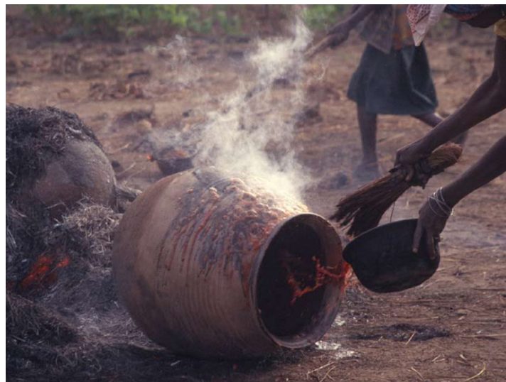
Figura 39. Tratamento pós-queima utilizando casca de bridelia ferrugínea . Aldeia de Kpalada, população de Tem-Kotokoli, Togo, 1997.
