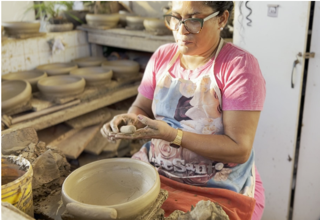
Figura 22. Paneleira Rejane preparando a "asa" do tipo alça para ser adicionada à proximidade da borda de uma frigideira (panela de moqueca).
